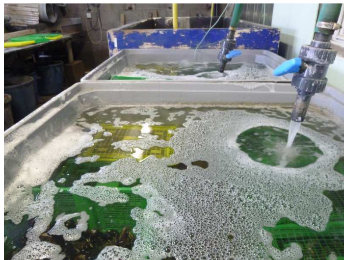
Les bassins en PVC ou en béton équipent les mas conchylicoles pour stockage ou épuration des coquillages
